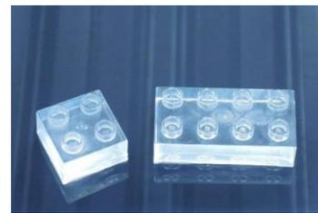
Dieses System ist für das Gießen von kleinen und größeren Gußteile ausgebildet und weist eine hohe Zähigkeit aus.
